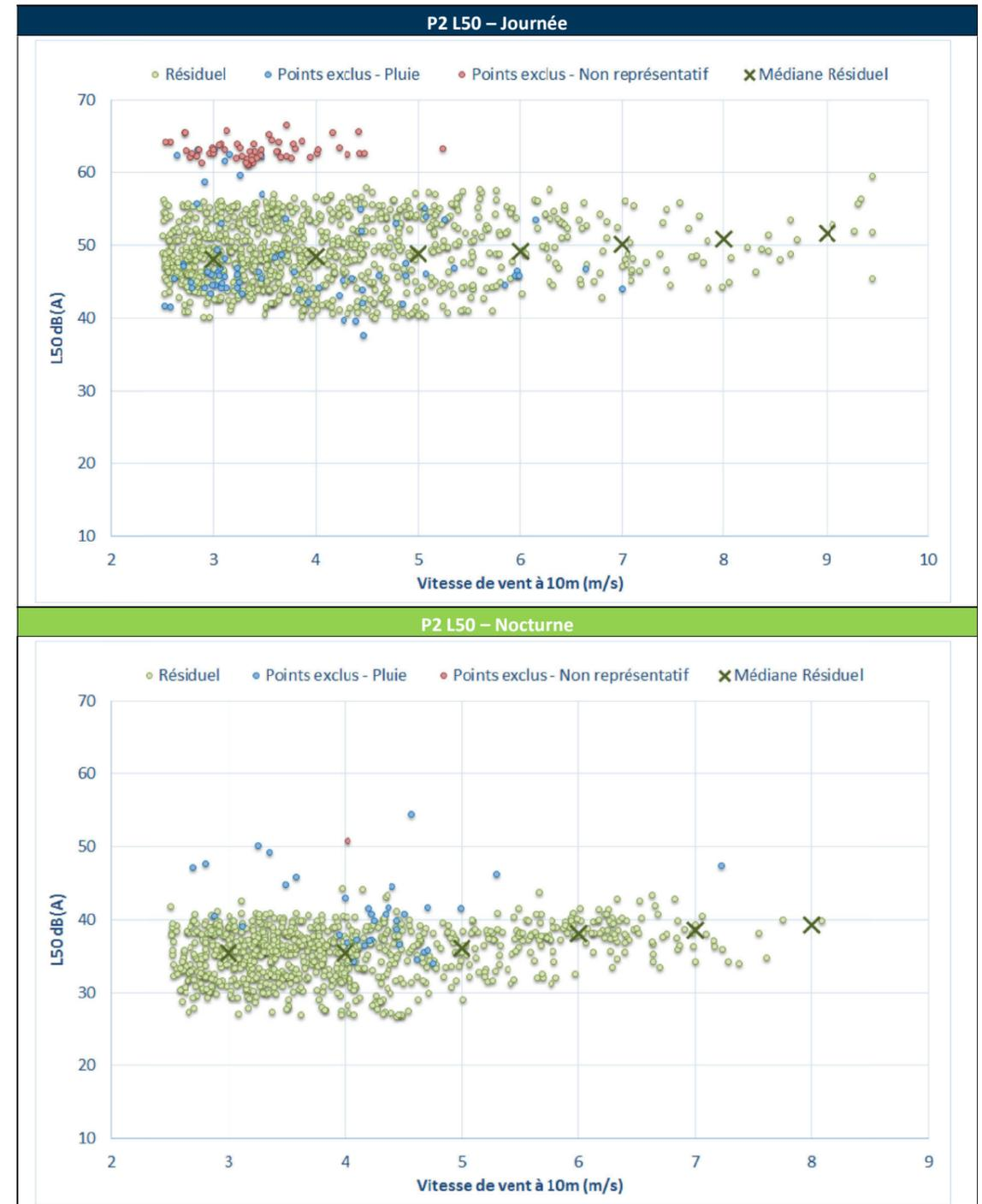
Figure 7 : Bruit en fonction de la vitesse de vent au point P2
